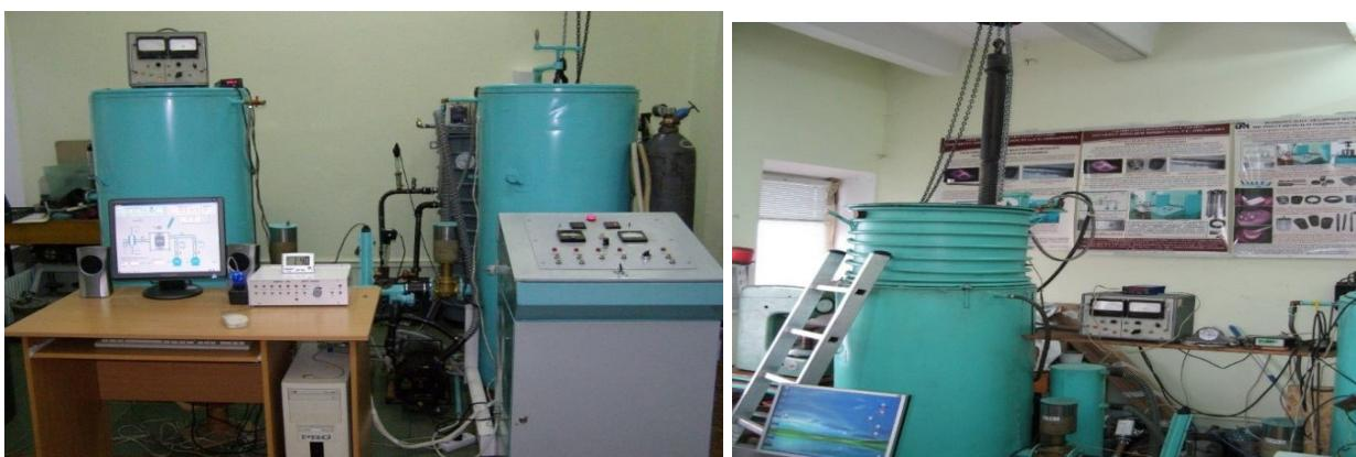
**Рис. 1 – Установка для импульсного ионного азотирования**
