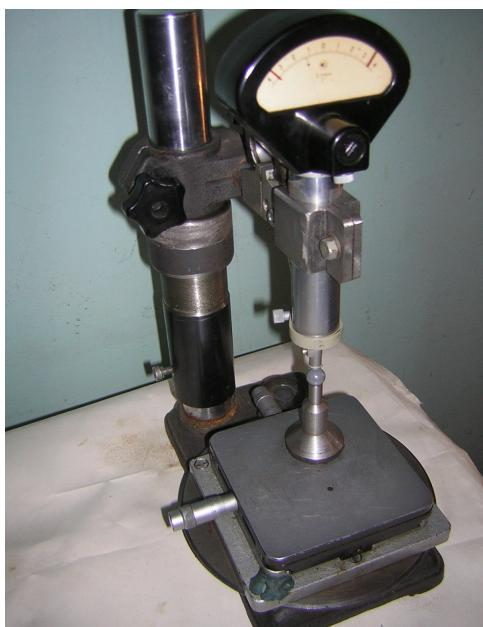
**Рис. 2 – Устройство для измерения величины отклонения сферичности керамического шарика**
