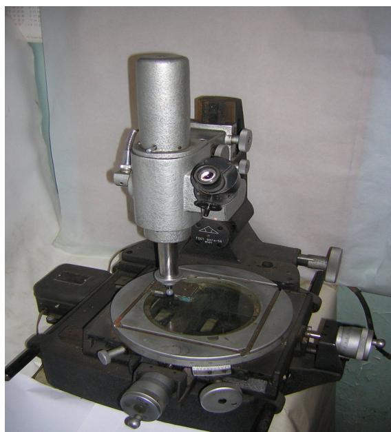
**Рис. 3 – Устройство для измерения диаметра керамического шарика**
