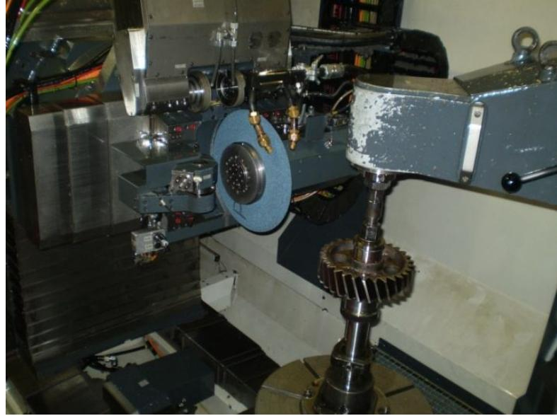
**Рис. 1 – Профильное шлифование зубчатого венца ротора кругом из золь-гелиевого корунда на станке «HÖFLER RAPID 1250»**
