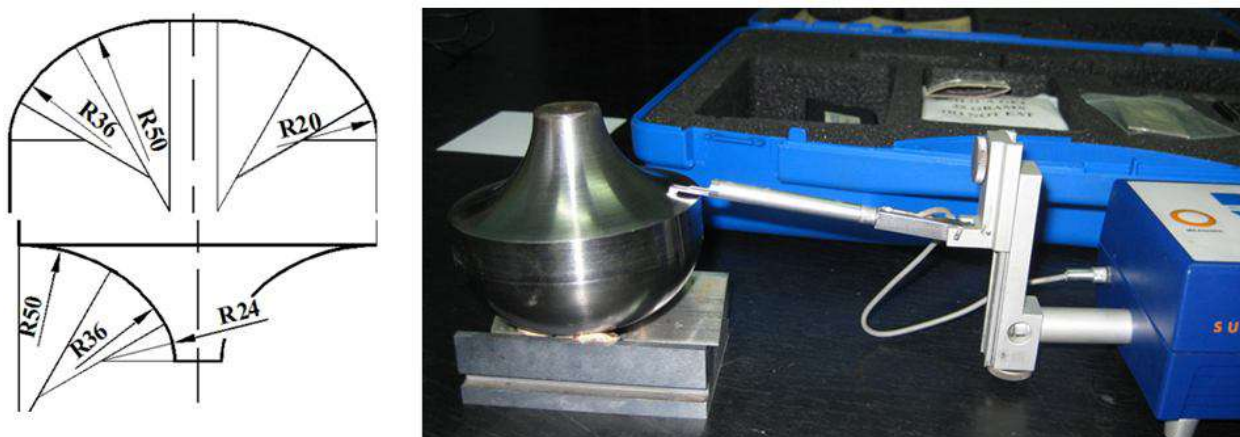
Рис. 1 – Вимірювання шорсткості R_a фасонної поверхні коли R дорівнює 24, 36, 50 мм переносним прецизійним профілометре SUYRONIC 25
