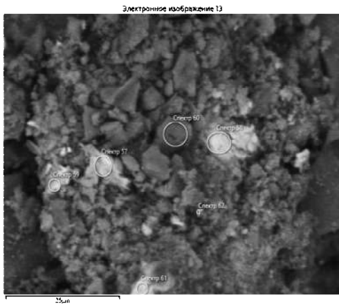
Рис. 1 – Загальний вигляд частинок зношування матриці із Cu-Sn на тлі частинок гірської породи, отриманий при застосуванні сканувального електронного мікроскопа ZEISS EVO 50 XVP
