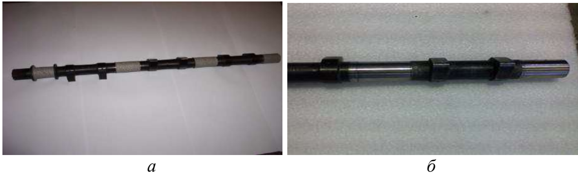
Рис. 2 – Розподільний вал 14-04-20-1 двигуна Д-160.111-1: а – відновлений; б – після механічної обробки
