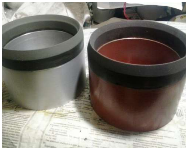
Рис. 2 – Чашкові шліфувальні круги із надтвердих матеріалів
