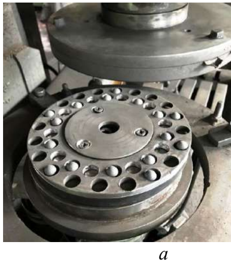
Рис. 1 – Ексцентричне розташування технологічного пристрою з сепаратором на столі верстату – а, й схема базування й подачі куль – б
