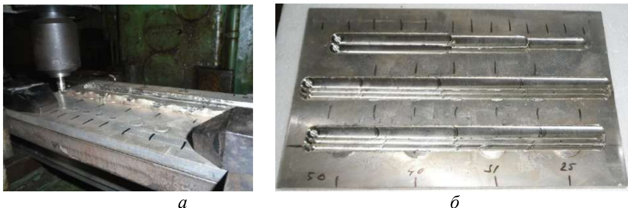
Рис. 2 – Загальний вигляд заварювання тертям з перемішуванням запресованих пробок у пластині сплаву МЛ10, що імітують поверхневі раковини-дефекти: а – процес заварювання, б – загальний вигляд заварених пробок
