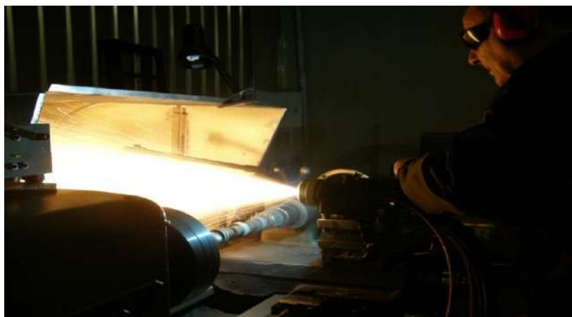
Рис. 1 – Процес відновлення розподільного валу електродуговим напиленням
