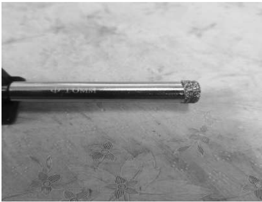
Рис. 1 – Зовнішній вигляд шліфувальної головки із синтетичного алмазу
