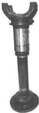
Рис. 4 – Карданний вал дизель-потягу Д-1: a – карданний вал в зборі; б – зношена ділянка вилки
