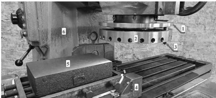
Рис. 2 – Установка для проведення експерименту: 1 – копій; 2 – спроектована торцева ступінчаста фреза; 3 – рухомий РЕ з контактом відносно копіру; 4 – динамометр; 5 – заготовка СЧ-21; 6 – вертикально-фрезерний станок 6Р12
