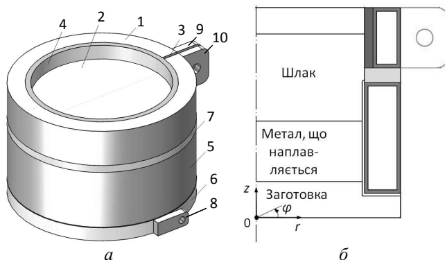
Рис. 1 – Двосекційний СПК – а ; права частина поздовжнього вертикального розрізу кристалізатора – б [4, 5]
