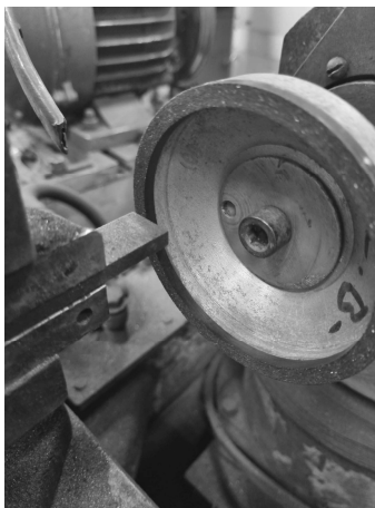
Рис. 1 – Шліфування загартованої сталі кругом із бурштинового КНБ
