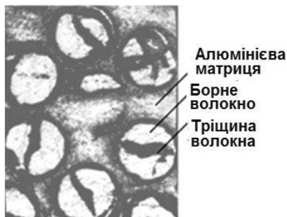
Рис. 1 – Мікрошліф поверхні МКМ Al-бор виконаний на растровому мікроскопі Zeis EVO 50 XVP [×2000]
