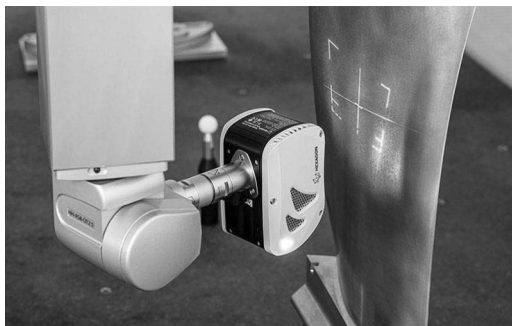
Рис. 1 – Безконтактний лазерний скануючий датчик HP-L-10.10, встановлений на КВМ Hexagon MI
