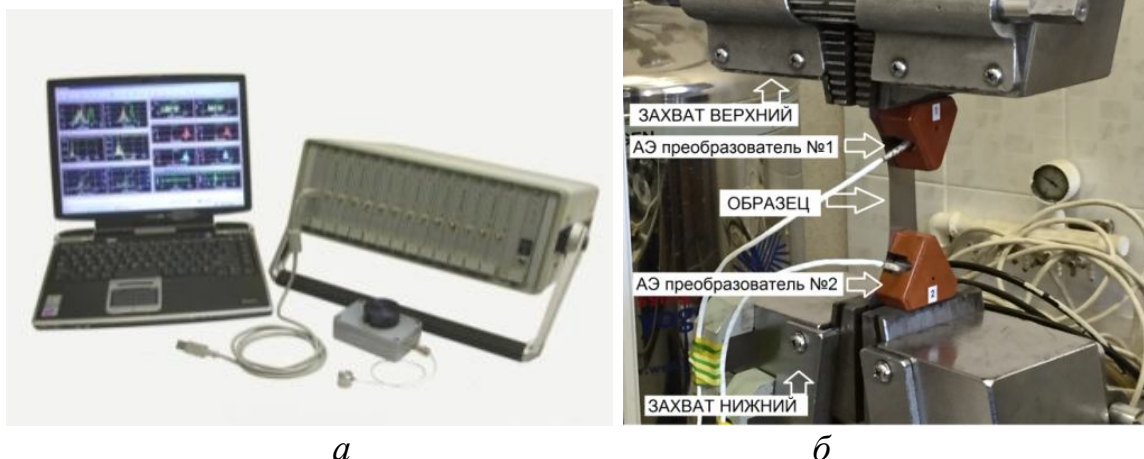
Рис. 2. Акустико-эмиссионная диагностическая система СДС1008 (а) и схема крепления преобразователей АЭ (D1-D2) на образце в захватах испытательной машины Instron 3382 (б)
