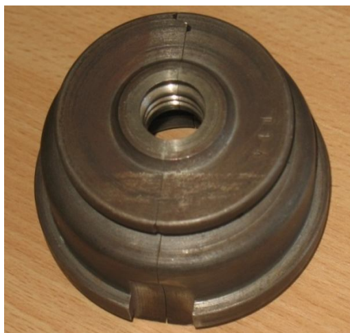
Рис. 2. Кільце горлове в зібраному стані (внизу – паз для захвату та фіксації кільця механізмом склоформувальної машини; вверху – фіксація положення суміщених півкілець за схемою «паз-виступ»)
